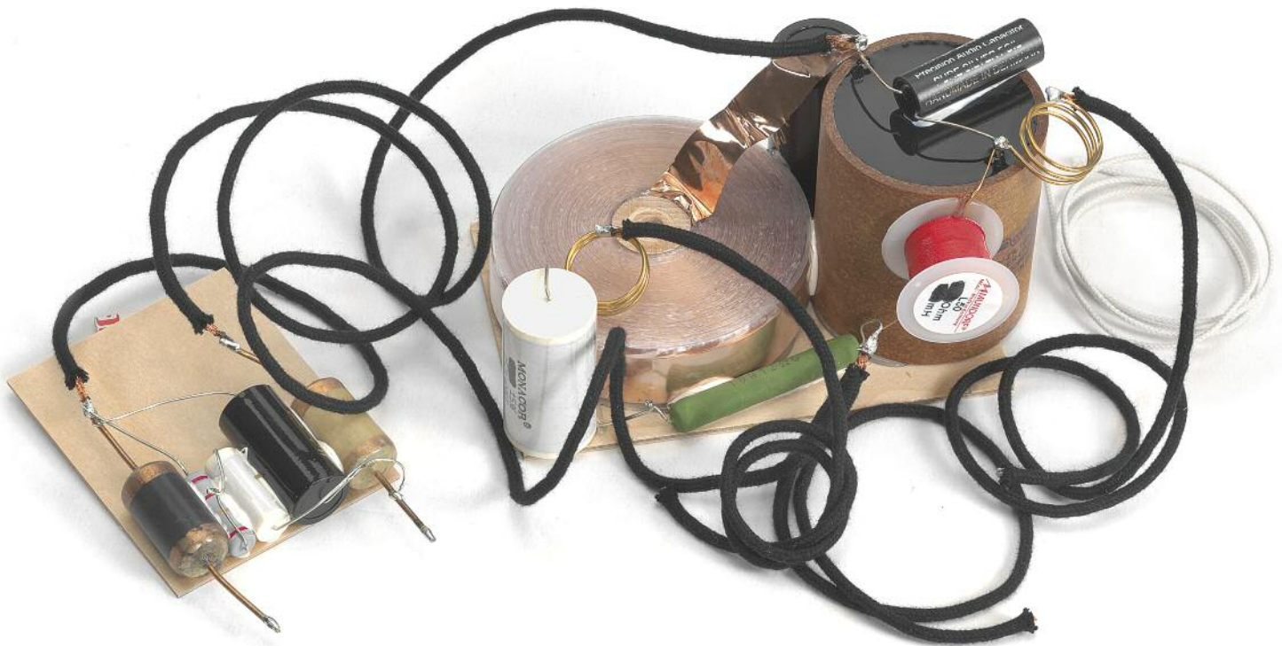
Frei verdrahtet und resonanzarm: Die Weiche ist nicht auf einer Platine aufgebaut, sondern wird auf eine Holzplatte montiert und dann für maximale Schwingungsarmut in das fertige Gehäuse geleimt. Der Kondensator mit verzinnter Kupferfolie stammt von Duelund
